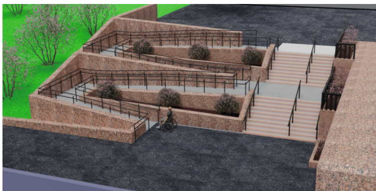
Рисунок 1. Обустройство пандуса при большом перепаде высоты.
